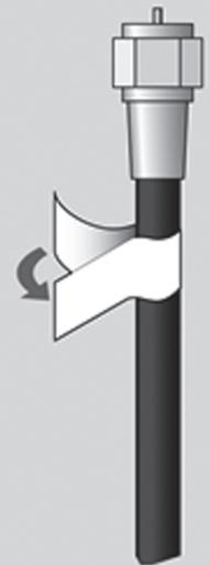
**Advertencia:** Ajuste las conexiones manualmente. Si utiliza herramienta puede forzar los conectores y provocar daños que no están cubiertos por la Garantía Limitada.
