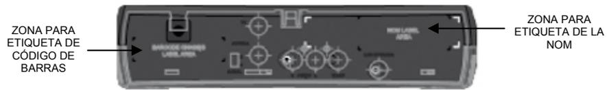
El panel trasero del receptor contiene las entradas necesarias para que conecte el receptor con otros aparatos electrónicos. También contiene el cable de alimentación. Dependiendo de la configuración deseada, sólo podrá usar algunas de estas entradas. Para información acerca del cableado y sus diagramas, consulte las instrucciones de instalación.
