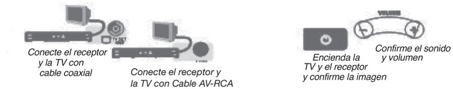
Conecte el receptor a la TV usando una de las siguientes conexiones:
